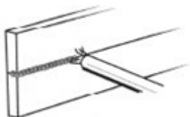
Рисунок 13. Горизонтальное положение при сварке
