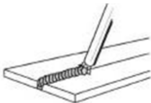
Рисунок 12. Нижнее положение при сварке
